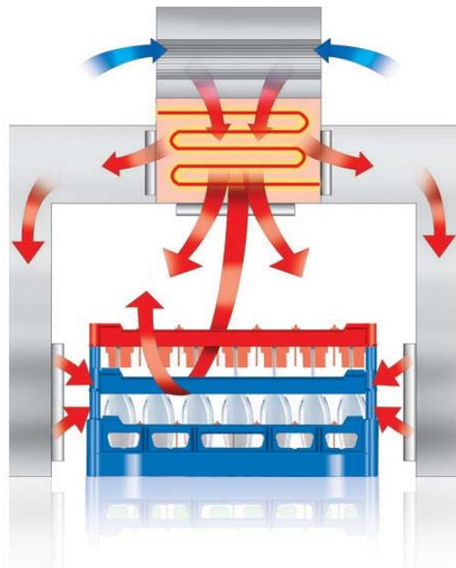
Une bonne circulation de l'air et donc un séchage efficace du contenu résultent en des verres très propres et permettent d'économiser du temps et des coûts d'essuyage.
