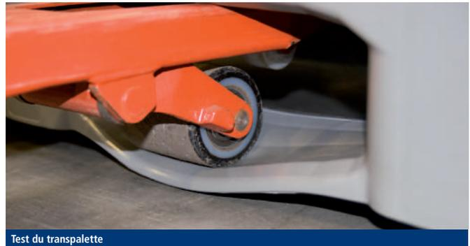
Pour le **test du transpalette**, les semelles et les raccords entre les pieds et les semelles et le plateau sont testés. Pour cela, les fourches du transpalette sont placées entre le plateau et les semelles, les roues reposant sur les semelles. On soulève ensuite les fourches pour écarter au maximum l'ouverture de la palette. Ce test est réalisé à une température comprise entre -20°C et +25°C.
